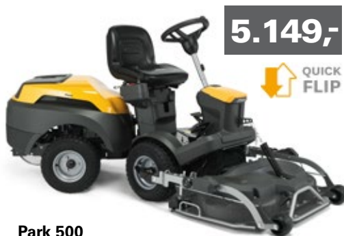
Park 500 Motor: 14,5 PK Aandrijving: traploos hydrostatisch Standaard maaidek: 95 cm Multiclip Hydraulische stuurbekrachtiging
