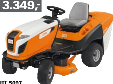
RT 5097 Motor: 13 pk Aandrijving: traploos hydrostatisch Maaidek: 95 cm
