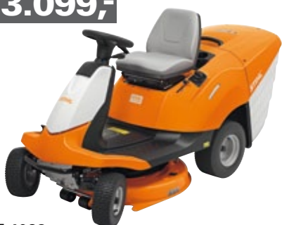
RT 4082 Motor: 13 pk Aandrijving: traploos hydrostatisch Maaidek: 80 cm - Uiterst wendbaar
